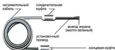
Нагревательные секции «HEATLINE-АНТИЛЕД» предназначены для обогрева водосточной системы и элементов кровли с целью предотвращения образования снега и наледи. Нагревательная секция представляет собой готовое электротехническое изделие, состоящее из двухжильного резистивного нагревательного кабеля постоянной мощности, соединительной муфты с установочным проводом и концевой муфтой. Подключение нагревательных секций к системе электроснабжения осуществляется с одной стороны.
